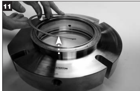
Afdichtingen met busset: Verwijder de veerring van het drukstuk en gooi hem weg.
