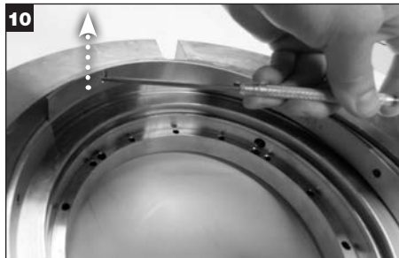
Afdichtingen met optionele injector: Verwijder de injector voorzichtig en leg hem opzij.
